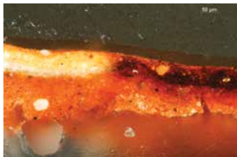
28. kép. Ólom-teszt a rétegcsiszolaton Figure 28. Hydrogen sulfide test on the cross section
